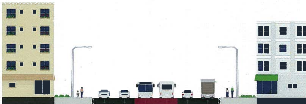
Figure 10 : Coupe schématique - Implantation du SRB au centre de la chaussée
