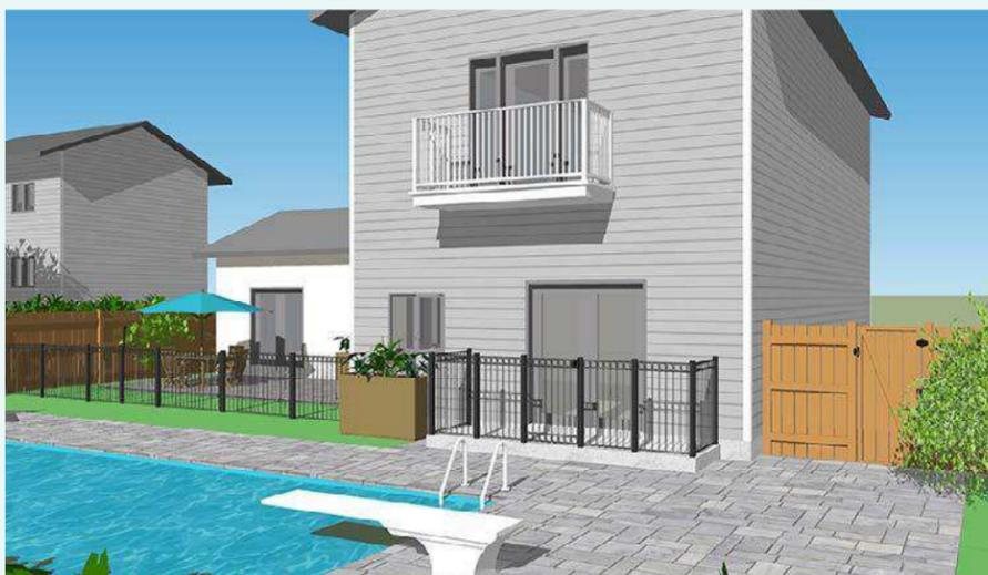
Exemple de balcon en hauteur, sans issue, dont les garde-corps ont une hauteur moindre que 1,2 m. Une telle configuration ne pose pas de problème.
