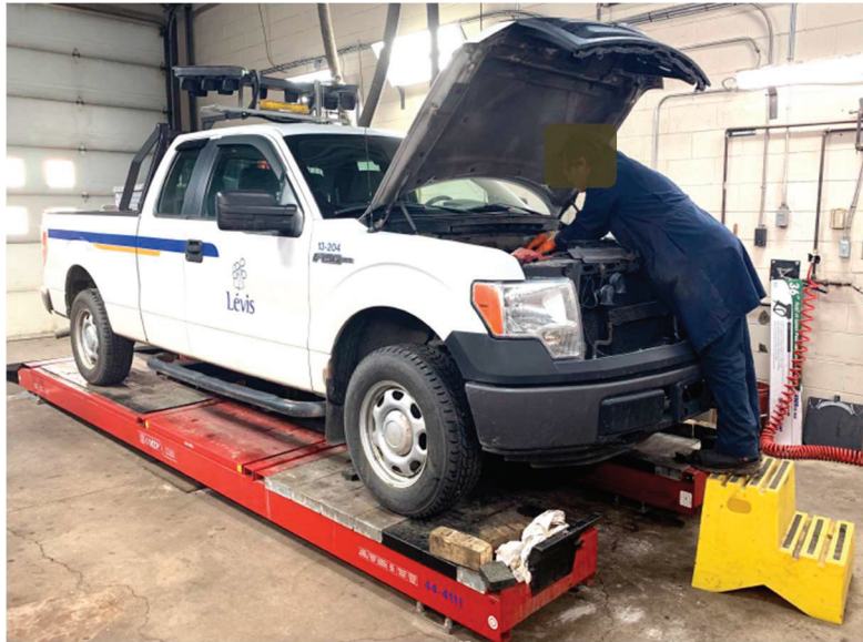
Photo 5 : Pratique non sécuritaire : pont élévateur non adapté, mécanicien juché sur un escabeau
