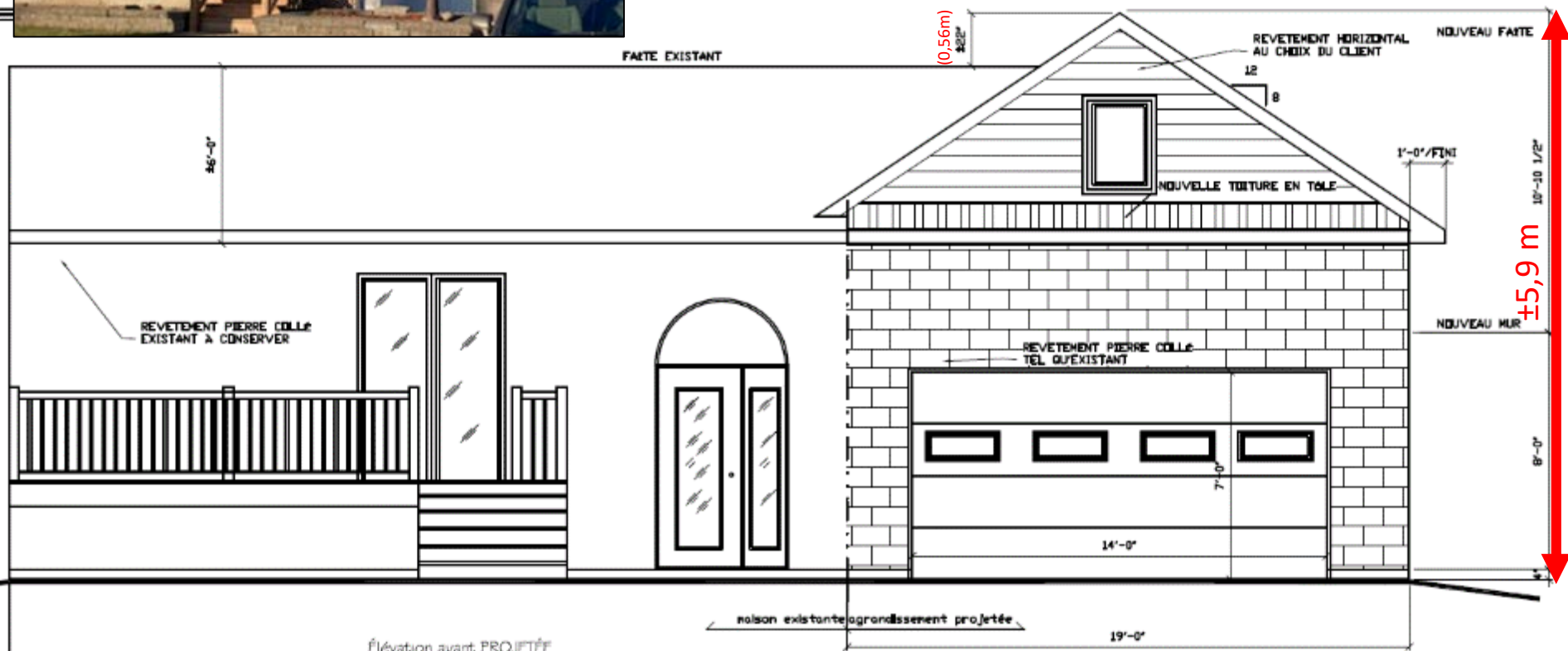
Élévation avant PROJETÉE
